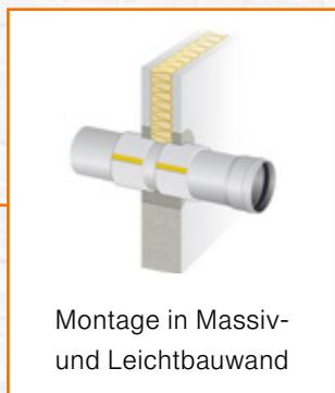
Montage in Massiv- und Leichtbauwand
